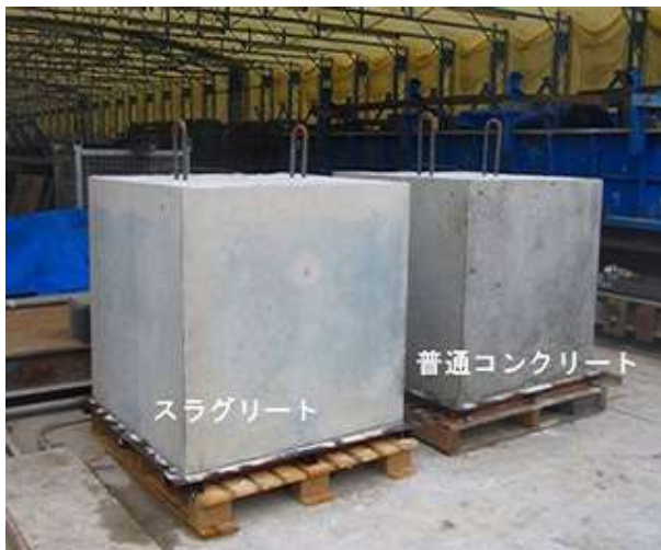
写真. スラグリートの状況写真
