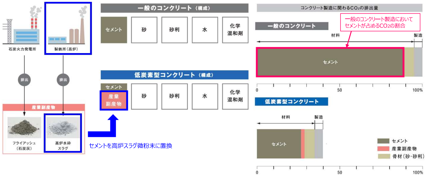
図. 産業副産物でセメントを70%代替した場合のコンクリート製造に係るCO 2 排出量
