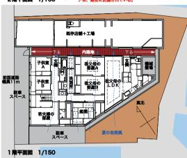
豪雪地である新潟県長岡市の中心街に立つ6人家族の2世帯住宅。四周を建物に囲まれた敷地には、家業である既存のクリーニング工場がある。中越地震で被害を受けなかったが、建築基準法により、構造的遡及が適用されるため、新築住宅とは接続していない。住宅と工場の間は大きな庇の付いた内路地で結んだ。
