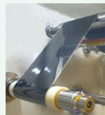
ペロブスカイト太陽電池（出典：積水化学HP）
