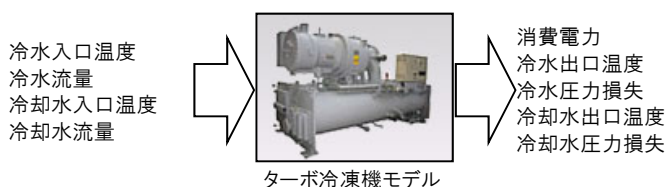
図 2.4.2.1-1 ターボ冷凍機モデルの入出力
