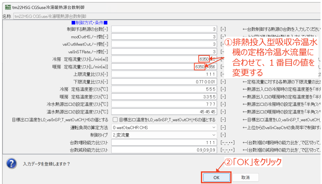
図 4.4.3 熱源台数制御モジュールの変更箇所
