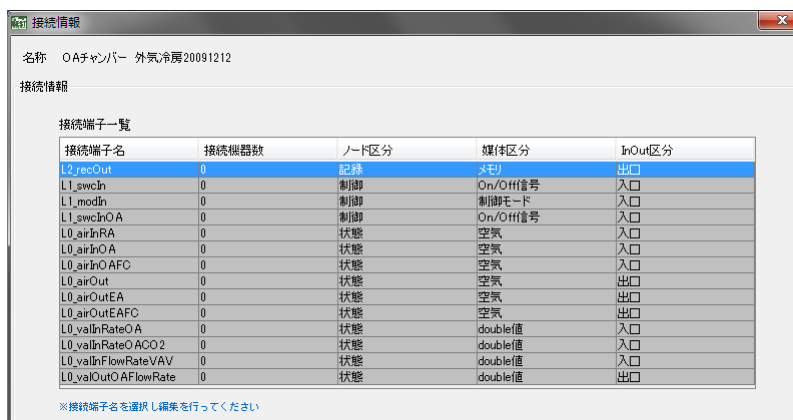
図 5-18 OA チャンバーモジュールの接続情報の画面
