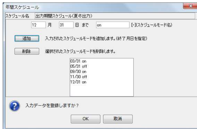
図 2-35. 夏冬のみ出力したい場合の年間スケジュールの入力例 (この画面はデフォルトではなく、入力画面の例である。)
