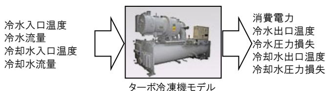
図 2.4.2.1-1 ターボ冷凍機モデルの入出力
