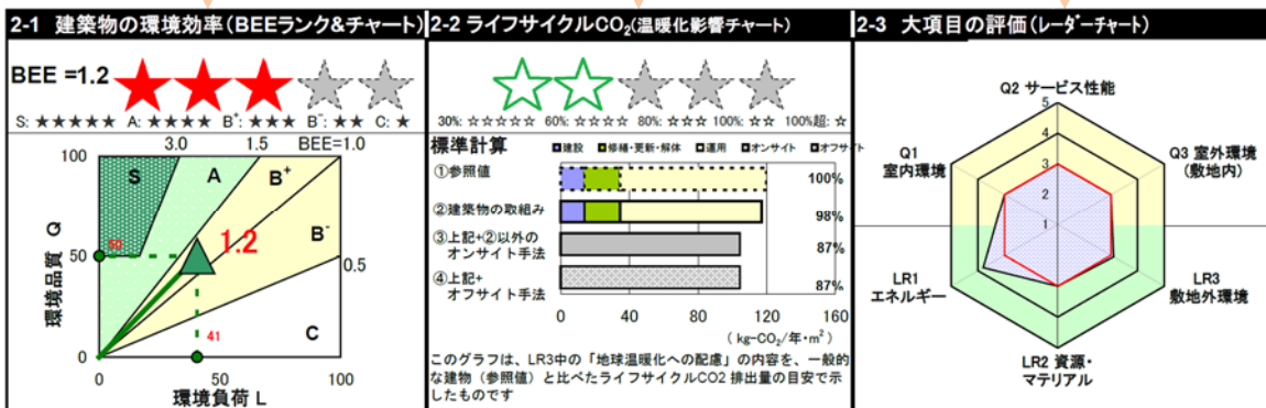
図3 CASBEEによる建築物の環境性能の「見える化」(評価結果表示シートからの抜粋)
