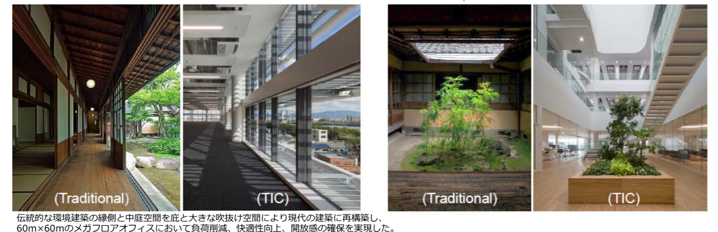
伝統的な環境建築の緑地と中庭空間を庇と大きな吹き抜け空間により現代の建築に再構築し、60m×60mのメガフロアオフィスにおいて負荷削減、快適性向上、開放感の確保を実現した。
